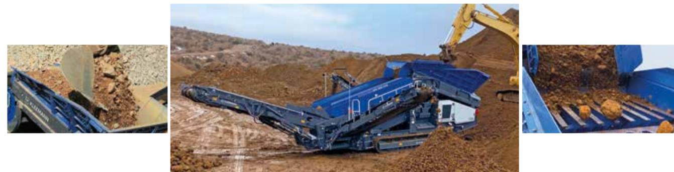
**Приёмный бункер MOBISCREEN MSS 802(i) EVO отличается большим объёмом для обеспечения оптимального потока материала.**
