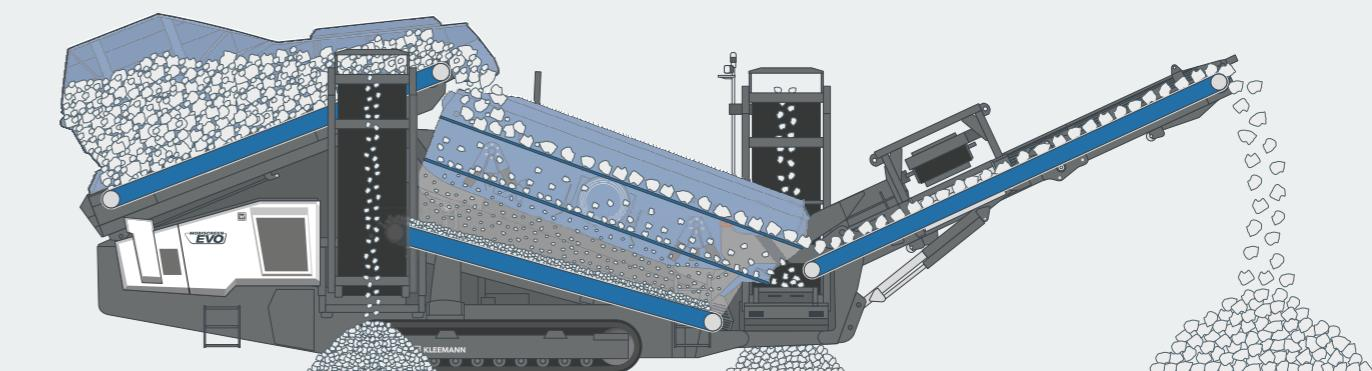
Благодаря шасси с пропорциональным управлением виброгрохот для крупнокускового материала можно быстро перемещать точно в нужное место, например от автомобиля с уменьшенной погрузочной высотой к месту эксплуатации или по территории карьера/строительной площадки. Складывание/раскладывание боковых разгрузочных конвейеров происходит без монтажа/демонтажа деталей, что позволяет сократить время переналадки. Конструкция бункера с задней
